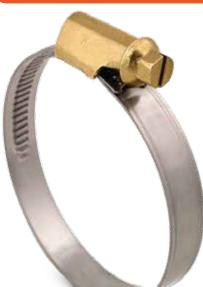
Fabricadas según norma DIN 3017 en acero inoxidable AISI 430. Carcaza y tornillo en acero SAE 1010 zincado con cabeza hexagonal. Bordes redondeados. Construídas con carcaza de una sola pieza sin soldadura, su corto asiento a la manguera forma con la banda estampada una óptima seguridad de apriete.
