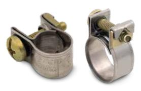
Fleje de 9 mm de ancho y 0,6 mm de espesor. Banda de acero inoxidable, tornillo y tuerca de acero zincado. El tornillo trae cabeza de ranura Phillips y paleta. Esta abrazadera es ideal para ser aplicada a mangueras para baja presión. Todas las medidas cierran un círculo perfecto asegurando la máxima eficacia en la sujeción. Mantiene permanentemente sujeta la tuerca en el extremo del fleje eliminando el riesgo de su pérdida.
